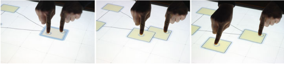
Abb. 5.9 Kopieren eines Knotens durch eine bimanuale Technik: Wird der Knoten gehalten und mit einem Finger der anderen Hand von innen heraus gezogen ( links ), erscheint eine Kopie des Knotens ( Mitte ) und kann entsprechend positioniert werden, ohne den Finger abzusetzen ( rechts )
