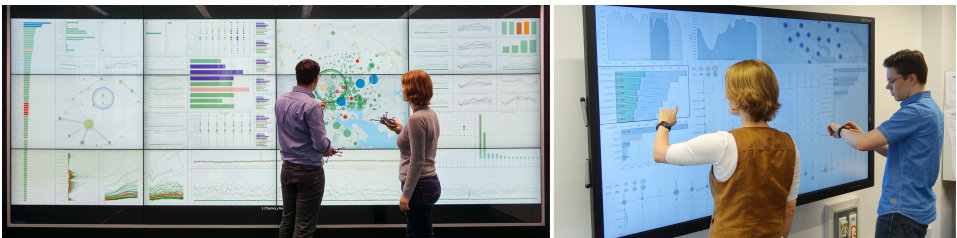
Abb. 2: Links : Displaywand mit multivariater Datenvisualisierung von Verbrechensdaten [LKD19]. Die kollaborative Datenanalyse erfolgt entweder per Touch oder aus der Distanz über ein räumlich getracktes Smartphone. Rechts : Analyse des gleichen Datensatzes in einer Multi-Displayumgebung, die ein Smartboard und mehrere Smartwatches miteinander verknüpft [Ho18] (Foto aus [Be24]).
