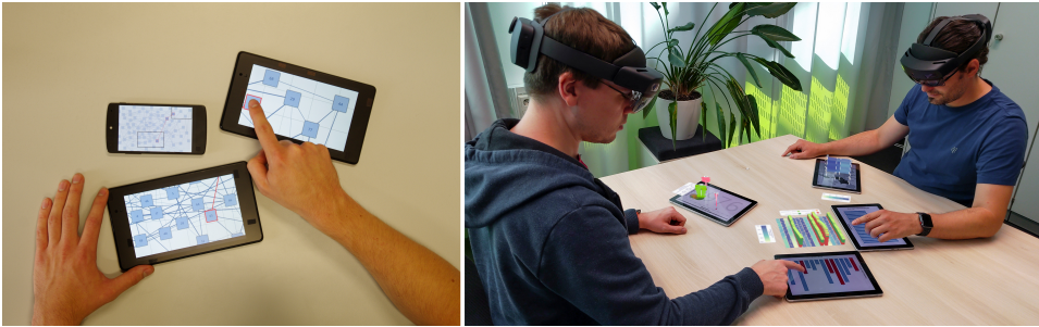
Abb. 1: Links: Bei VisTiles [LHD18] werden mehrere mobile Endgeräte miteinander verbunden und die Visualisierungsansichten aufgrund der räumlichen Beziehung zueinander synchronisiert. Hier sieht man ein Overview-Tile (Handy) und zwei Detail-Tiles (Tablets). Rechts: Im MARVIS-Projekt [La21] werden auf, über und neben mobilen Endgeräten (mit 2D-Views) dreidimensionale Informationen mittels AR-Brille überlagert. Im Bildbeispiel erzeugt die räumliche Anordnung zweier Balkendiagramme ein augmentiertes 3D-Balkendiagramm zwischen den Geräten (Foto aus [La21]).
