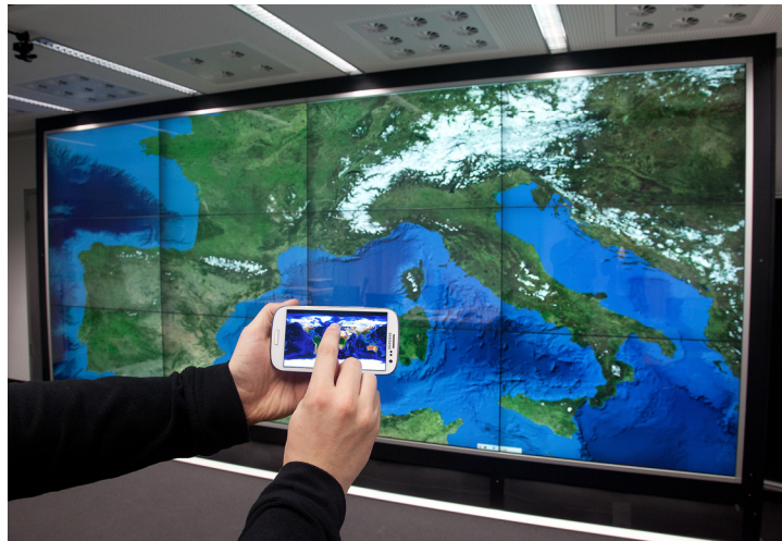
Abb. 1 Interaktive Visualisierungswand mit 24 Megapixeln am Interactive Media Lab Dresden. Zoom & Pan über Touchbedienung auf einem Smartphone, das gleichzeitig einen Gesamtüberblick bietet.
